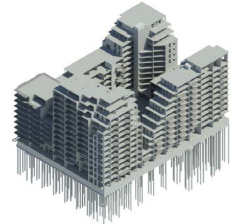
De wandenstructuur van de appartementen is perfect afgestemd met de kolommenstructuur van de onderliggende parkeergarage.
